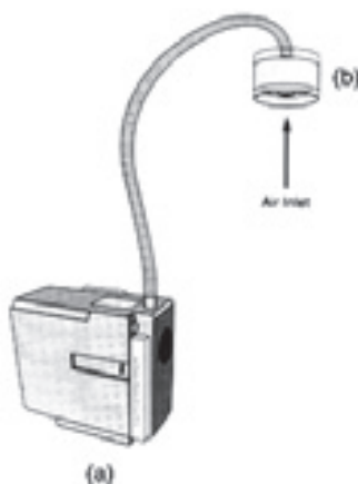
شکل شماره ۳: نحوه قرارگیری کاست فیلتر و ورودی هوا در هنگام نمونه برداری
