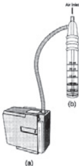
شکل شماره ۲: نحوه قرارگیری میدجت ایمپینجر به هنگام نمونه برداری
